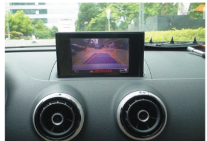
6. Отображение видеоинтерфейса. (Автоматическое включение при переключении на заднюю передачу).
